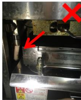
油ろ過機・油受けを入るとガスホースに接触する可能性がある。(参考写真)
