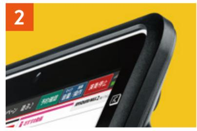
**2 エラストマー樹脂の保護により、破損リスクを低減**
